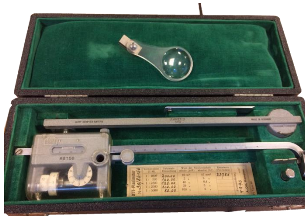
Planimeter der Firma Ott, Kempten
