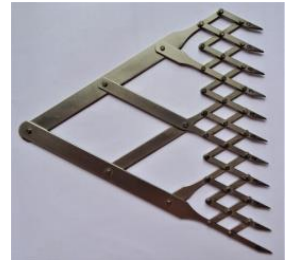
ab den 1980er Jahre Interpolationszirkel auch als Streckenteiler bezeichnet
