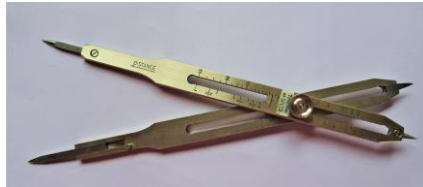
ab den 1980er Jahre Interpolationszirkel auch als Streckenteiler bezeichnet
