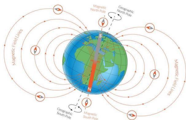
Wenn die Magnetnadel angewendet wird, richtet sich diese genau an den Feldlinien aus. Sie orientiert sich im Magnetfeld am Süden, was dem geografischen Norden entspricht.
